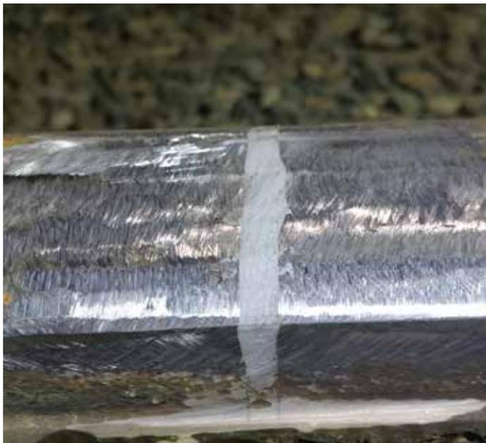
Belzona 1221 (Super E-Metal) est un composite bi-composants de réparation d'urgence basé sur un système polymère renforcé par de l'acier céramique. Ce produit Belzona entièrement usinable peut être utilisé pour le collage permanent, les réparations ou les reconstructions des composants métalliques.
