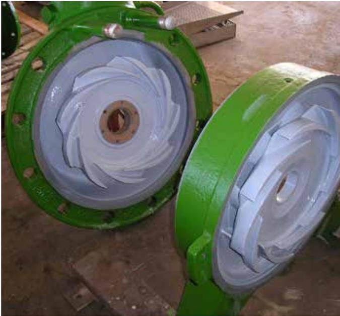
Belzona 1341 (Supermetalgilde) est un système de revêtement bi-composants conçu pour améliorer le rendement de l'équipement de traitement de fluides et protéger les métaux contre les effets de l'érosion et de la corrosion.
