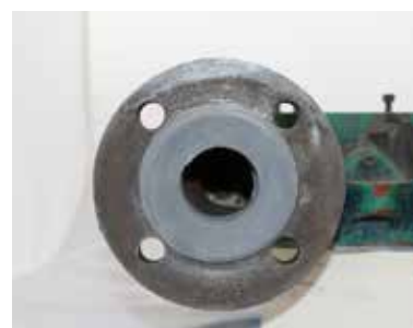
MOULE RETIRÉ, FACE RÉPARÉE MISE AU JOUR
