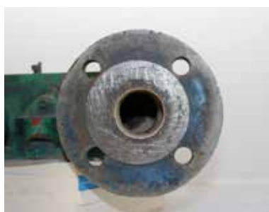
SURFACE DE FACE DE BRIDE PRÉPARÉE
