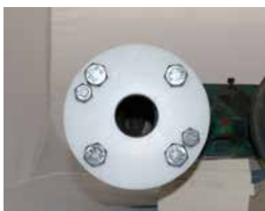
BELZONA ET MOULE APPLIQUÉS
