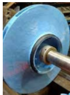
Belzona 1131 (Bearing Metal) Composite de réparation du métal à base d'époxy autolubrifiant hautes performances.
