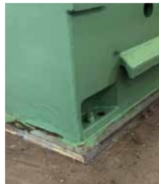
Belzona 7111 Matériau de calage/jointoiement sous forme coulante conçu pour s'étaler uniformément sur les surfaces inégales afin de leur conférer une résistance aux chocs physiques et thermiques.
